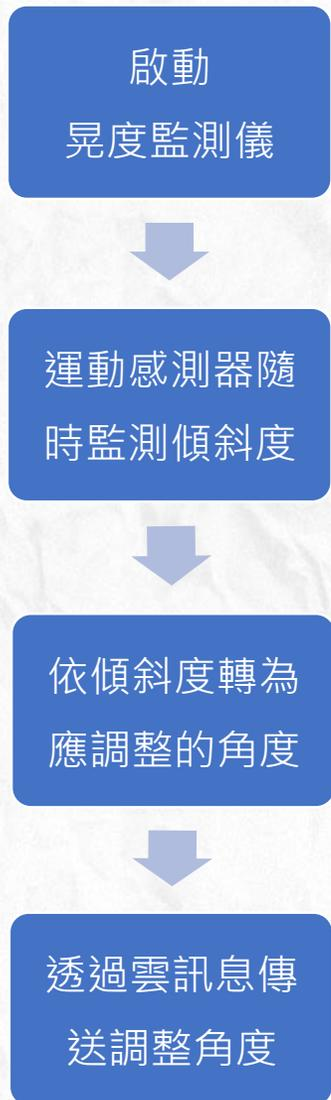
(檢測光環板的運動，包括加速度、傾斜、震動、旋轉角度)
