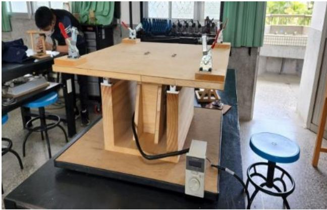
圖十五、模擬地震的震度儀器裝置
