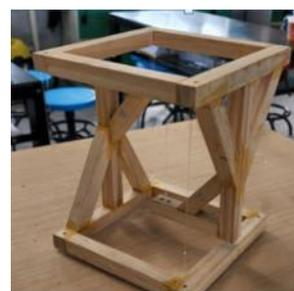
圖十一、加上桁架的改良版張拉整體結構
