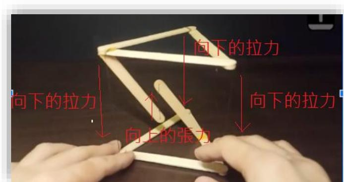
圖十、張拉整體結構原理
