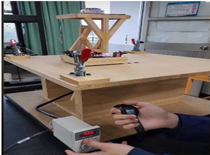
圖二十四、對加裝了「懸浮抗震系統」的張拉整體裝置進行緩震測試
