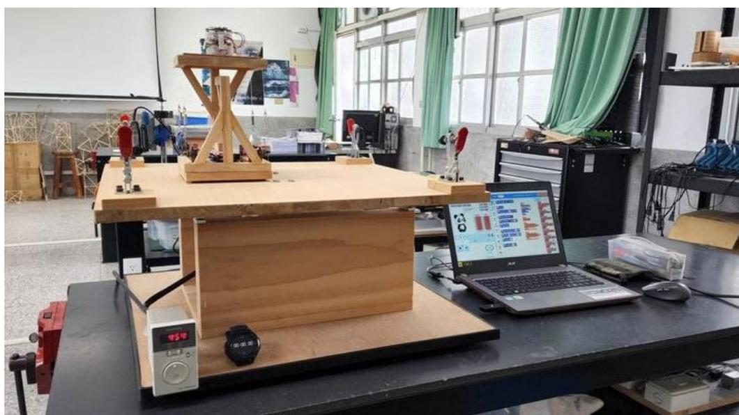
圖二十五、進行測試「懸浮抗震系統」緩震效能的實驗
