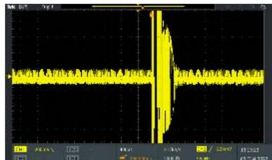
波形2. 超音波陣列發射前方故障訊號時的接收波
