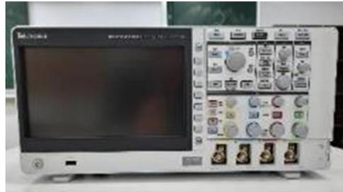
圖 11. Tektronix 太克 TBS2104B 數位儲存示波器
