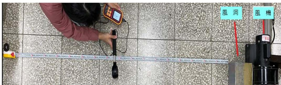
圖 7：測量風機距離與風速的關係
