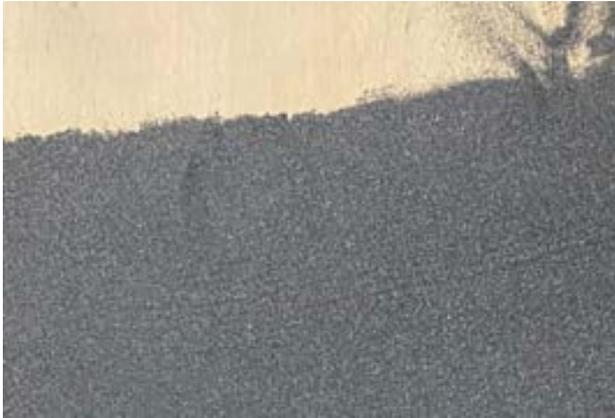
圖 73：實驗室中以風速 2m/吹 24 小時的結果：只能看到不明顯的直脊狀砂波紋
