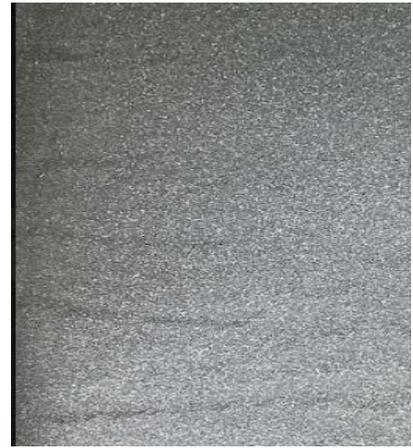
圖 47：風機在 150 公分處，第 15 分鐘時砂波紋的外形
