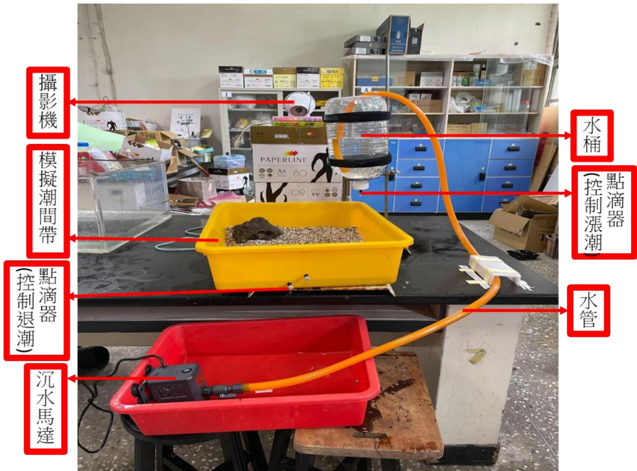
圖 4-3-37 模擬潮汐設備
