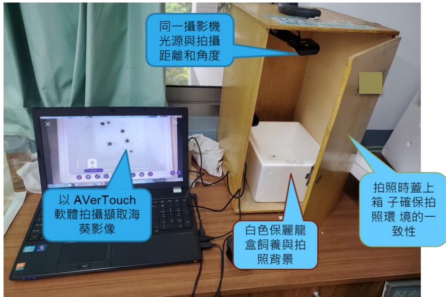
照片 8 以固定距離和光照的拍照設備拍攝海葵照片
