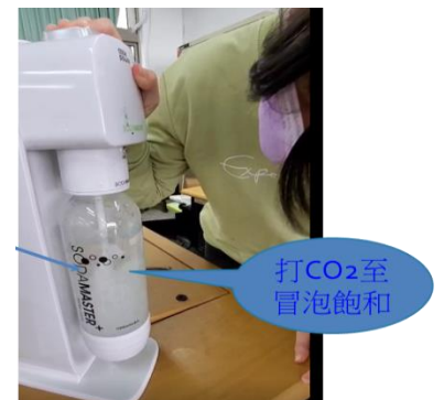
照片 14 以氣泡水機製造飽和 CO 2 海水
