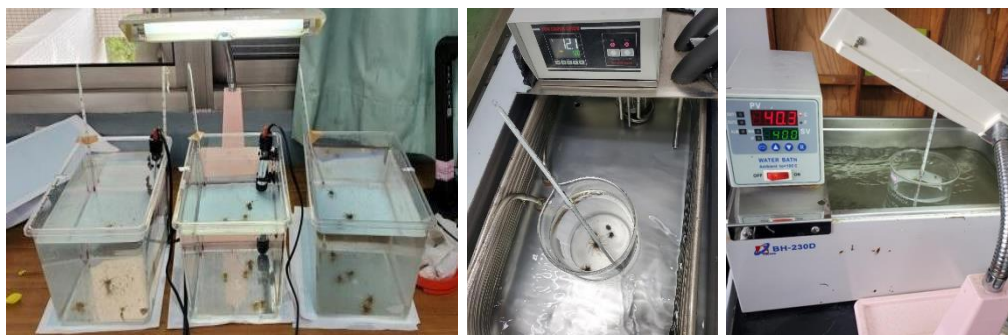
照片 12 溫度控制實驗的恆溫調節裝置
