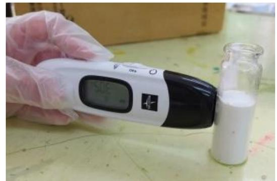
用表面溫度計測量溫度
