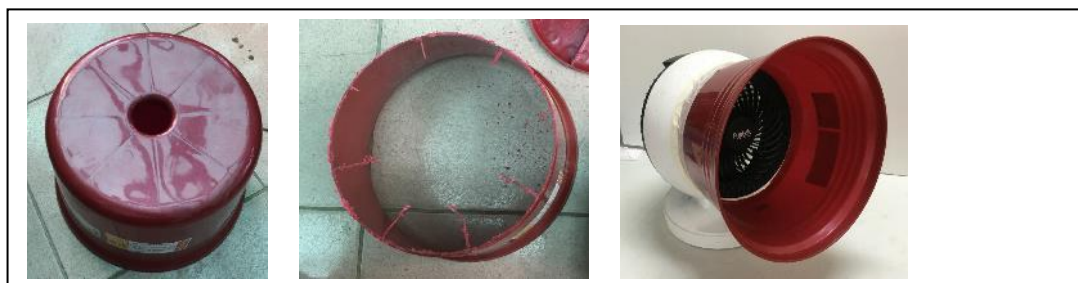
圖 9、將塑膠椅切割，組裝到電風扇，自做一個風洞。
