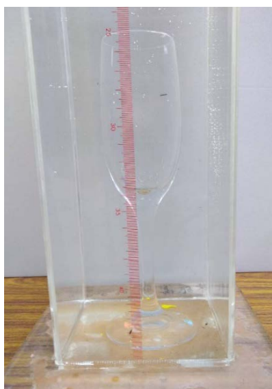
(圖七) 玻璃杯沒入裝有水的水位測量器裡
