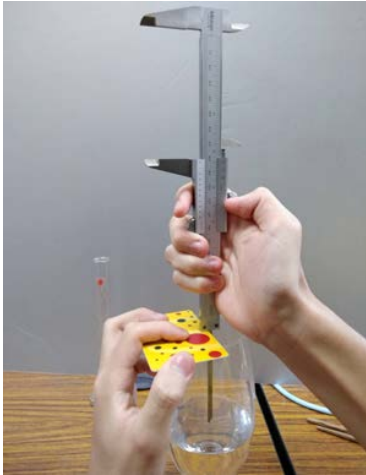
(圖五) 用硬卡當橋樑，再用深度桿測量玻璃杯在特定水量的深度(扣除卡片的厚度)
