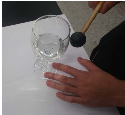
(圖二) 音叉槌敲擊杯口的方式
