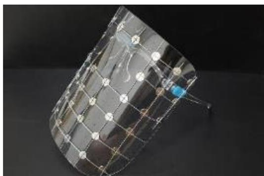
圖 6-1 自製防電磁波面罩
