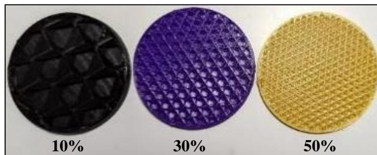
圖 8 不同填充率圓板在 3D 列印下的填充方式
