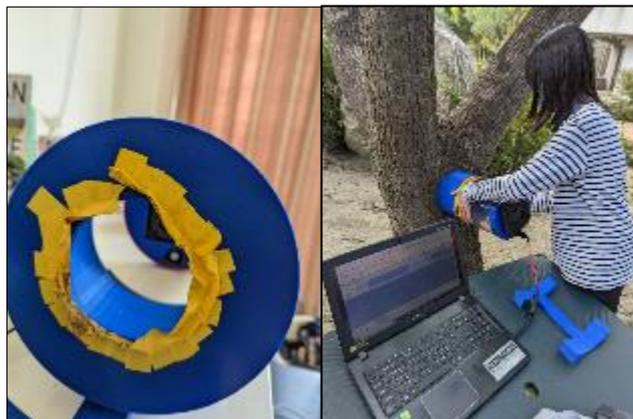
圖 25 吸音管緊貼樹幹偵測反射聲音
