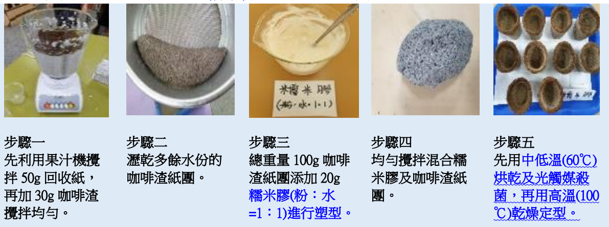
圖 4-2-1 加入天然黏膠與咖啡渣混合製成環保紙容器的過程
