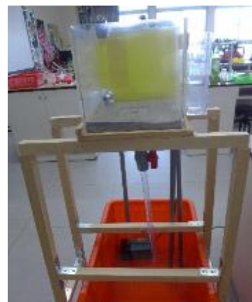
壓克力箱、木條製作成水力循環系統
