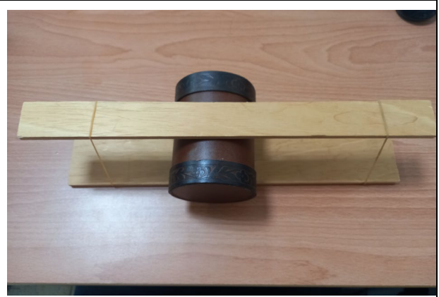
加上橡皮筋模擬用手握住時的力度
