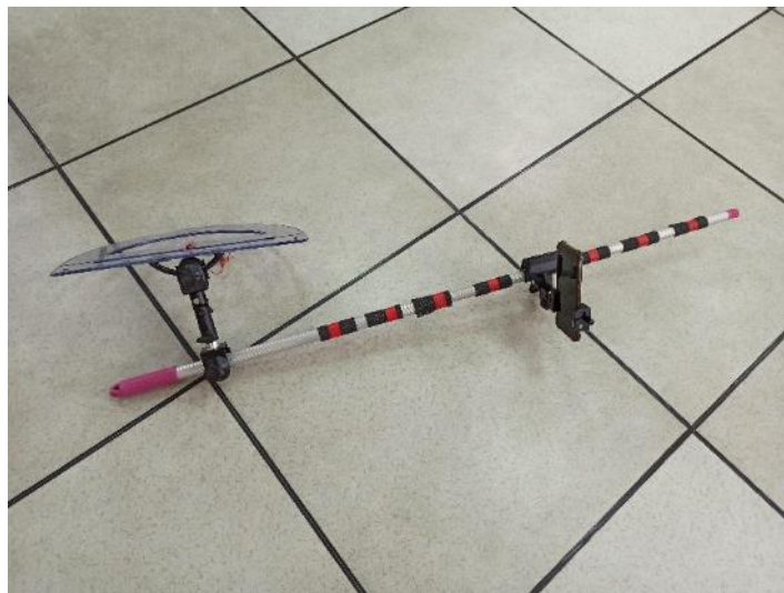
手杖上裝設有量角器確定實驗時角度的正確
