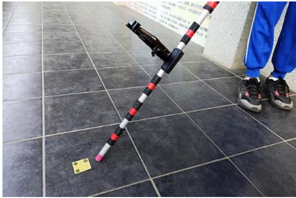
QR Code 邊長 5 公分 鏡頭在手杖的位置 20 公分 手杖與地面夾角 30 度
