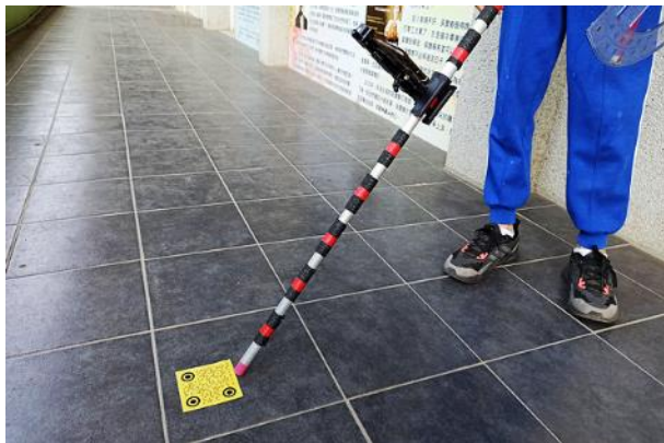
QR Code 邊長 10 公分 鏡頭在手杖的位置 60 公分 手杖與地面夾角 60 度
