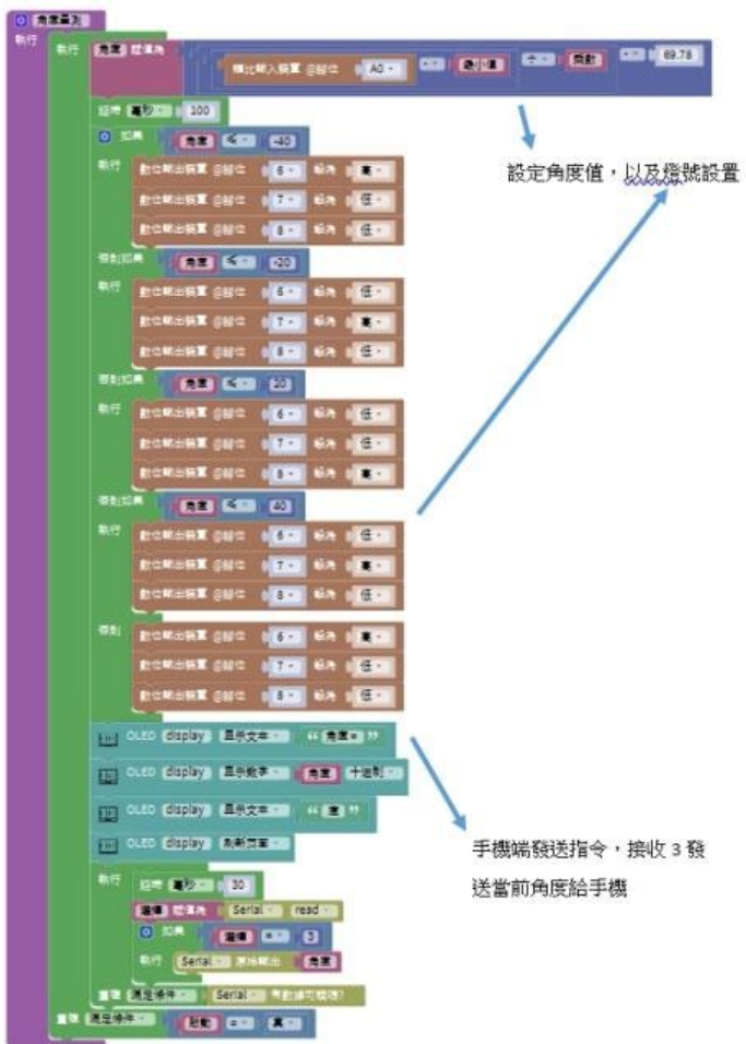
圖62 Arduino 透過藍芽模組跟手機上的 App 聯繫的程式設計圖 + Arduino 程式設計
