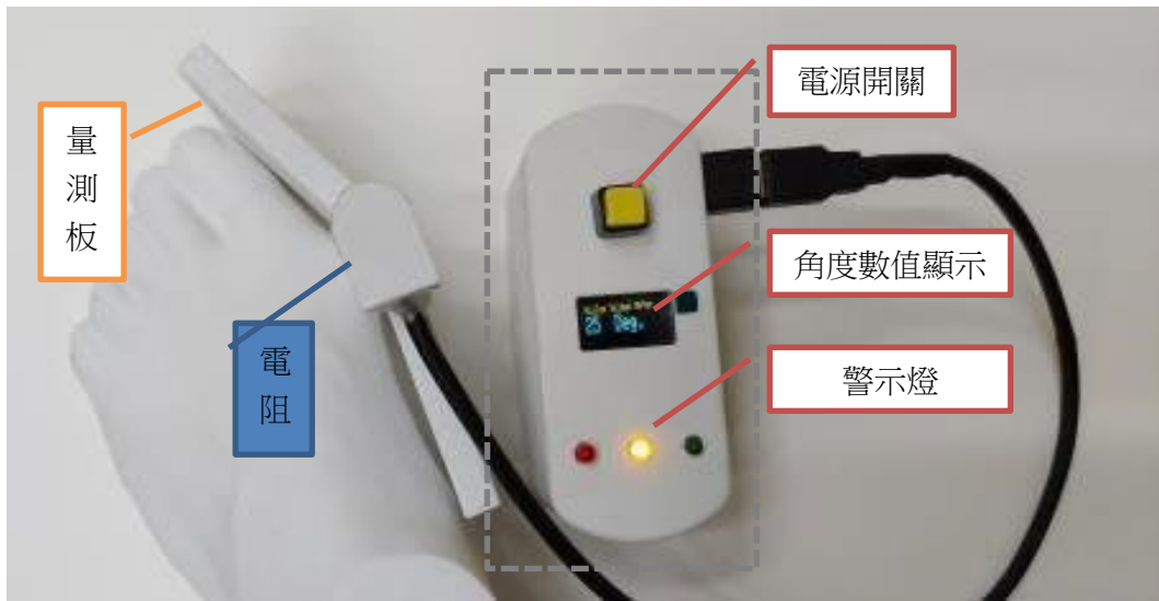
圖44 Arduino 電位差測量 3D 模型裝置
