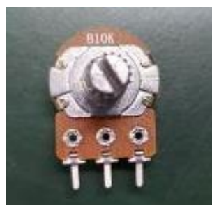
圖33 檯燈上的旋鈕大多是靠可變電阻改變燈泡亮度，於是想利用可變電阻來當作檢測角度的工具
