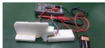
圖4 第二代-電阻轉換檢測裝置
