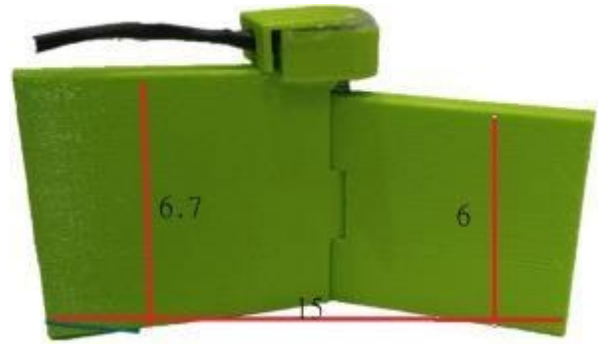
圖42 第一蹠骨與大拇趾側板固定量測
