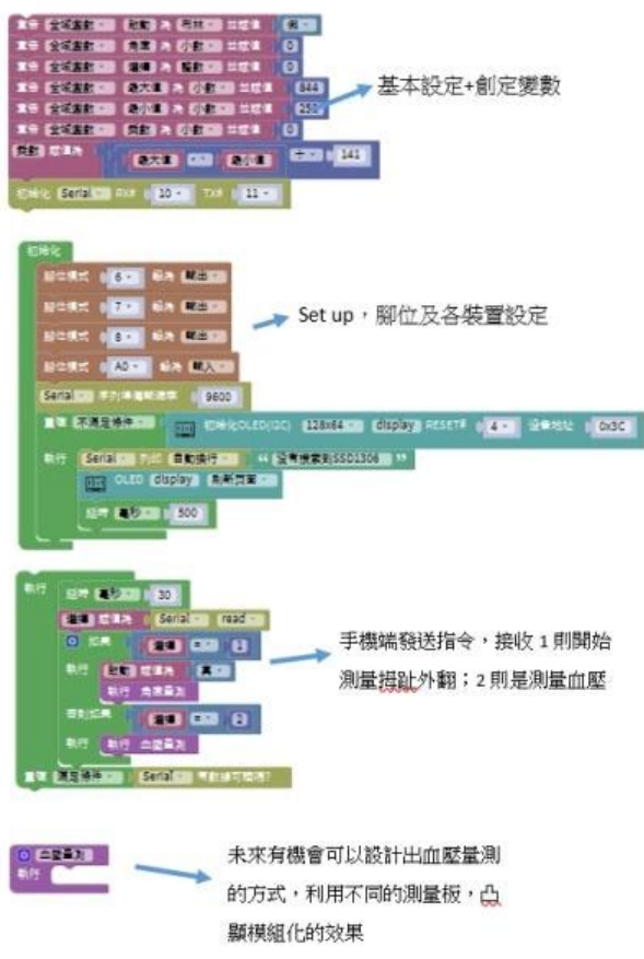
圖62 Arduino 透過藍芽模組跟手機上的 App 聯繫的程式設計圖 + Arduino 程式設計
