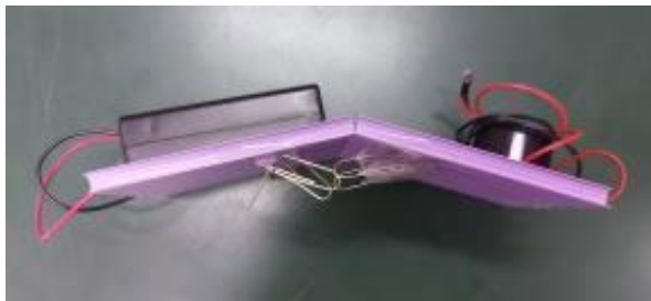
圖30 改良後，使其可以在內夾角小於 160 度時讓燈泡發亮，140 度時蜂鳴器會發出聲響。
