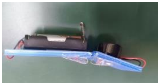
圖29 改良用 PP 瓦楞板，但只能測出一種角度
