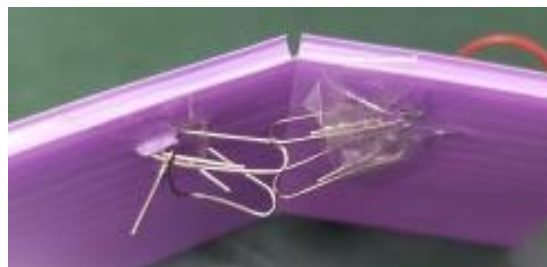
圖30 改良後，使其可以在內夾角小於 160 度時讓燈泡發亮，140 度時蜂鳴器會發出聲響。
