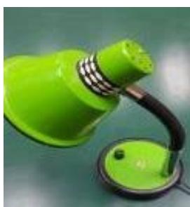
圖33 檯燈上的旋鈕大多是靠可變電阻改變燈泡亮度，於是想利用可變電阻來當作檢測角度的工具
