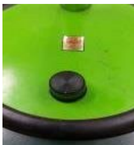
圖33 檯燈上的旋鈕大多是靠可變電阻改變燈泡亮度，於是想利用可變電阻來當作檢測角度的工具
