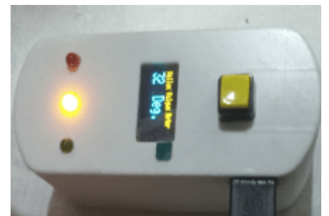
圖50 度數顯示於螢幕上同時亮起警示燈號
