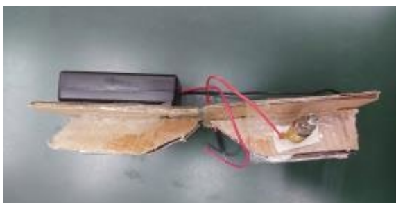
圖28 紙箱瓦楞板，太軟容易破損
