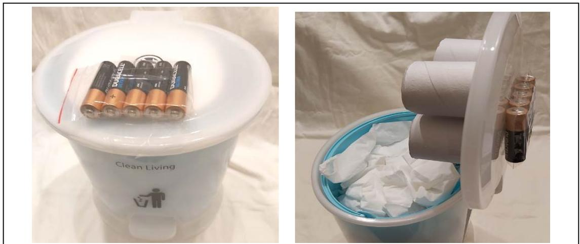
4. 觀察發現：在垃圾桶蓋上增加重量，黏上 5 顆 3 號電池(21 克)時，可以達到下壓的重量，筒狀式垃圾桶蓋可以完全將衛生紙壓下去，但是垃圾桶會不穩，蓋子重底部不穩也不行，所以改用金屬製垃圾桶 3L(直徑 17cm，高 20cm)，因為金屬製的垃圾桶本身就重，蓋子也重，鐵製蓋子的重量足夠將衛生紙壓下去，所以解決塑膠垃圾桶蓋子加重後不穩的問題 (如圖 8)。
