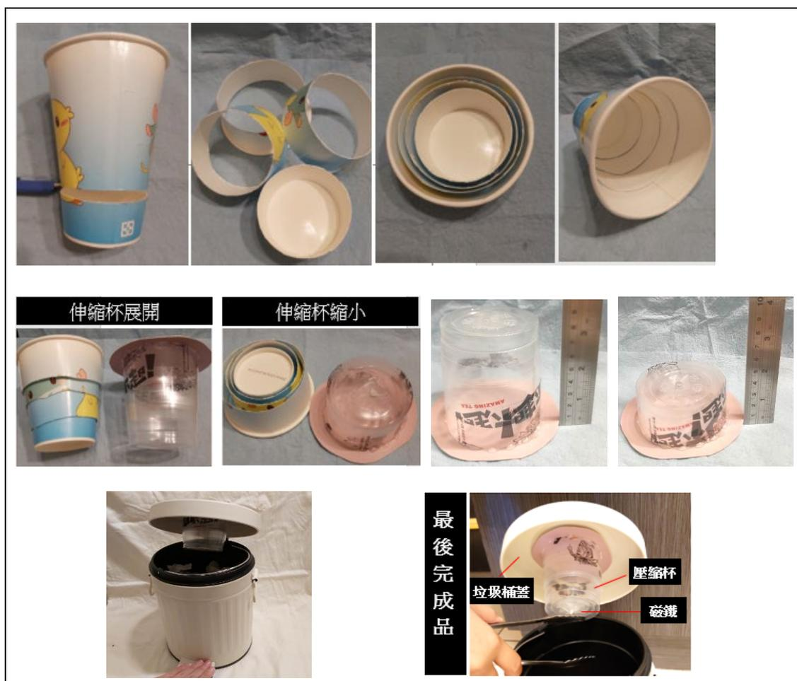
5. 觀察發現：紙杯容易切割、但清洗多次會爛掉；手搖塑膠杯有一定的硬度，可重覆清洗使用。自製伸縮裝置拉開時高度為 8.5cm，壓縮後高度為 3.5cm，並且可以平均慢慢變縮回，改善了筒狀式壓蓋之壓縮筒固定 5cm 高度問題。
