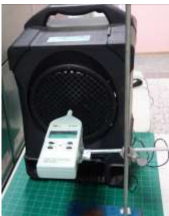
圖 6-19：調整分貝計與喇叭的距離
