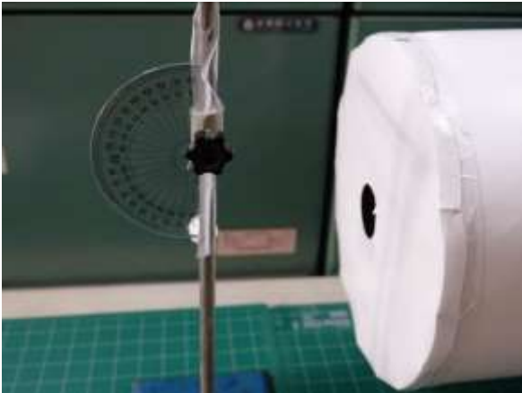
圖 6-15：測量麗龍球擺盪的角度與聚音筒距離之關係(1)
