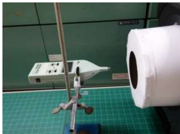
圖 6-14：測量音量與聚音筒距離之關係
