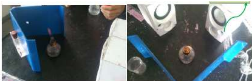
圖 6-5：利用聲波的反射滅火(1)
