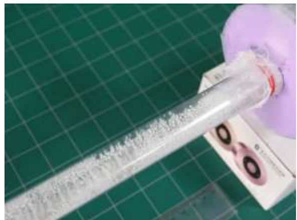
圖 6-64：輸出聲音觀測駐波的形成及型態
