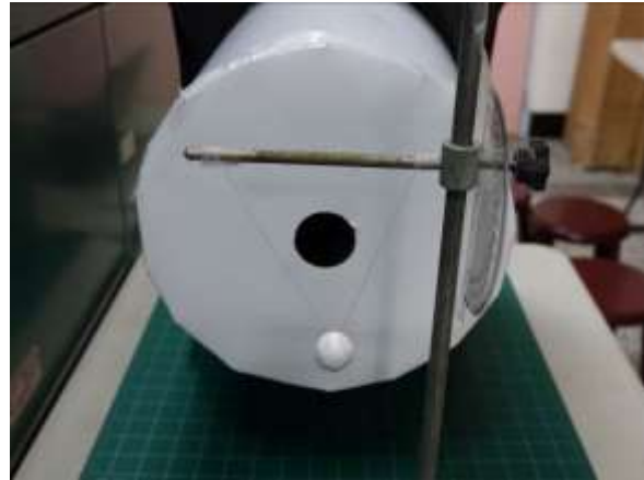
圖 6-16：測量麗龍球擺盪的角度與聚音筒距離之關係(2)
