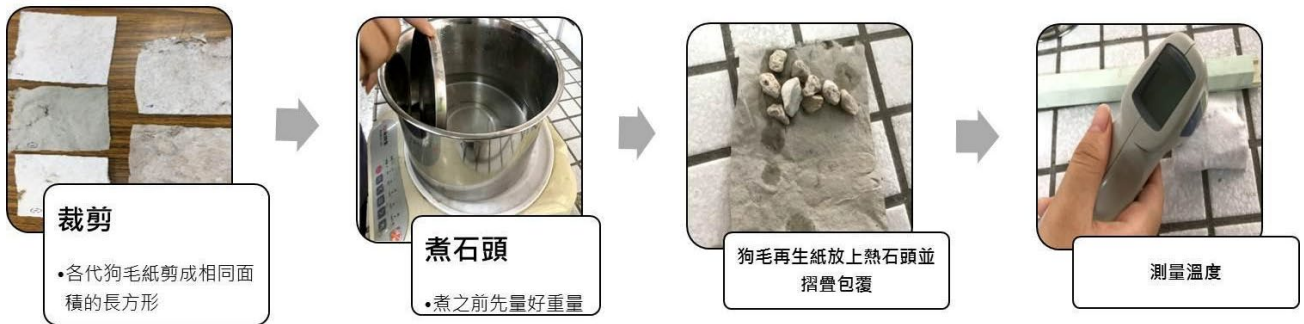
圖 4-4 各代狗毛紙保溫性測試步驟
