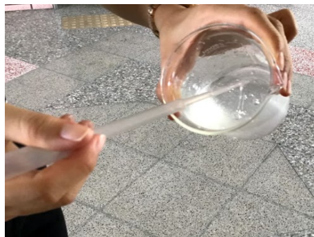
圖 4-11 些許樹糊粉先加水混至如蛋白狀，再加入紙漿盆中
