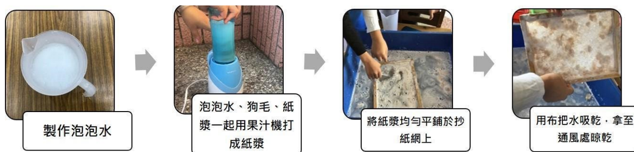
圖 4-3 製作完全狗毛紙之實驗步驟
