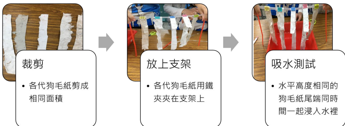
圖 4-6 各代狗毛紙吸水量測試步驟
