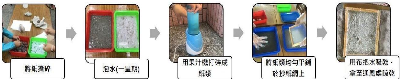
圖 4-2 初步製作狗毛與紙混合之實驗步驟
