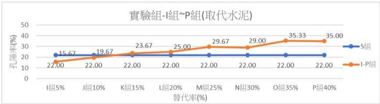
圖 5-8：實驗組 I 組~P 組，會呼吸的智慧多孔創新材料試體孔隙率試驗結果統計表
