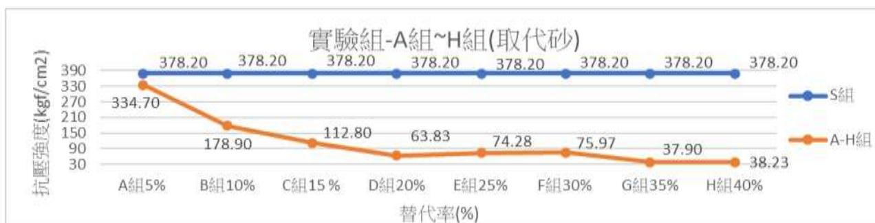
圖 5-4：實驗組 A 組~H 組，會呼吸的智慧多孔創新材料試體抗壓試驗結果統計表
