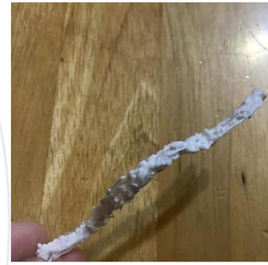
4.最後以3D列印筆沿著平放桌上間隔約0.5cm的兩把尺，**成功**完成不易斷裂PLA鼻樑。
