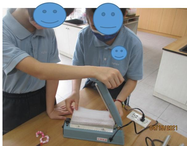
(1)搭配鈕扣型耳掛，加上自製鼻樑並以家用封口機將內、外層黏合即完成實驗。
