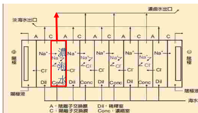
圖 21 電析法離子交換膜過濾方式
