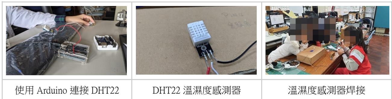
第一次我們連接 arduino 和 DHT22 準備量測濕度時，發現每一顆 DHT22 所輸出的數據相差太大，分別濕度 99%、85%、34%，但是當天(2020/12/24)中央氣象局的濕度大約在是 75%~80%(中午 12 時~13 時)之間，後來我們細細檢討，測試了不同電腦、不同開發板，最後猜測有可能是已經買來 3 年的 DHT22 生鏽導致失準，於是我們又從網路上買下新的 DHT22，重新安裝、測試後，終於不同的 DHT22 顯示數據差距在 1%左右，且與中央氣象局的濕度差不多。
