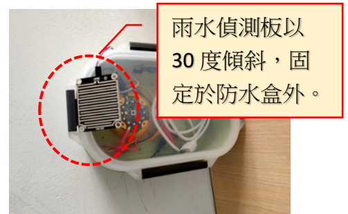
圖 35 組裝完成的降雨偵測模組
