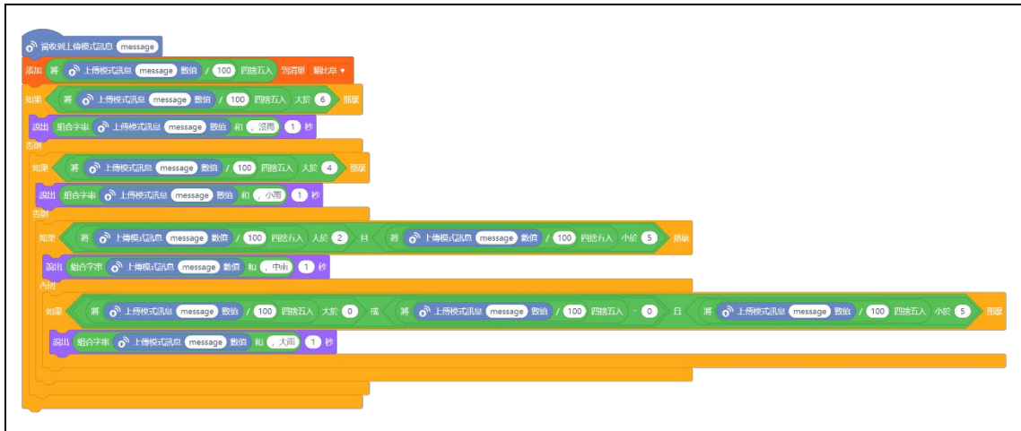
圖 35 根據感測數值可判斷「沒雨」、「小雨」、「中雨」及「大雨」的程式
