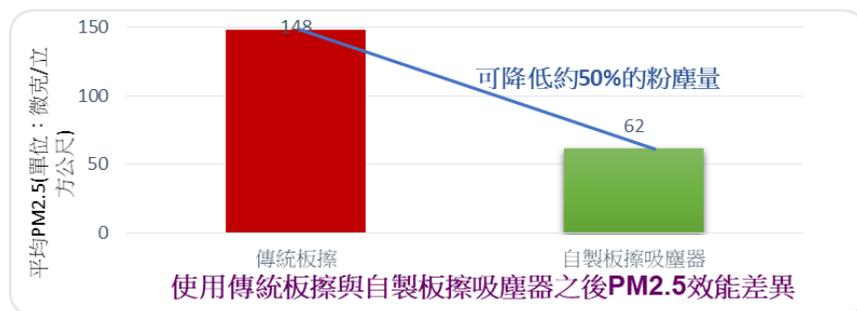
23. 由上圖得知，以粉塵量最多的教室前排(講桌)在使用我們的自製板擦吸塵器之後，教室內的空間粉塵量約可降低 50%。
