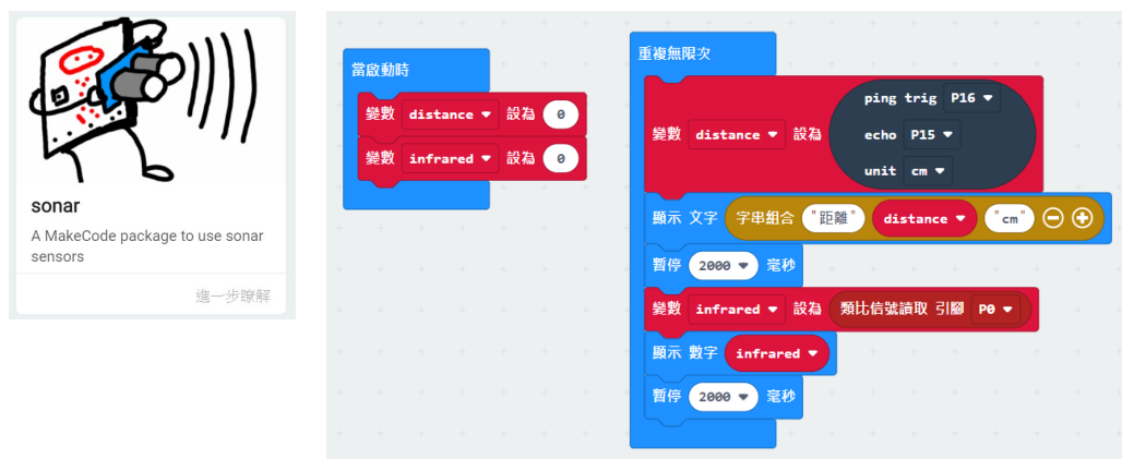
圖十四：設定兩個腳位接收和發射超音波來實測對於金屬和衣服顏色材質的實際接收狀況。根據理論說明的接收時間所以我們設定 2000 毫秒來避免接收誤差。
