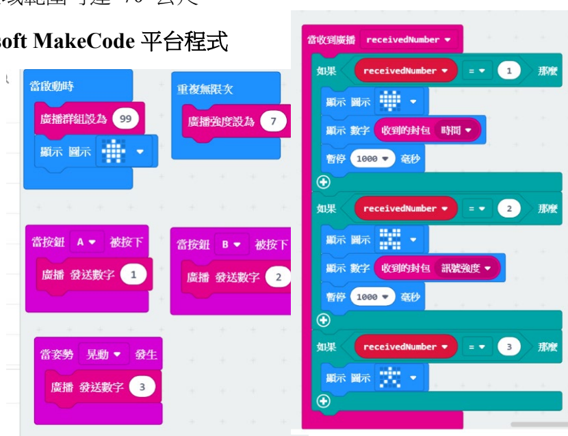
圖十七：設定廣播強度來測試不同距離(有無障礙物)接收到的訊號強度、接收時間。
