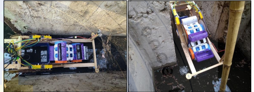
水溝前進，偵測陰井障礙物
