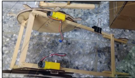
△車架前輪(直徑5cm)棘狀後輪(直徑19cm)
