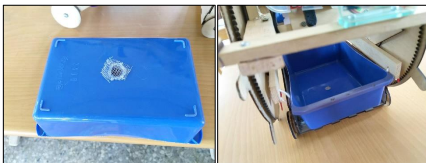
圖 40.收集水槽下方挖洞
