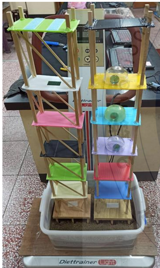
單斜撐、阻尼球建築物 黏合樁基礎模型
