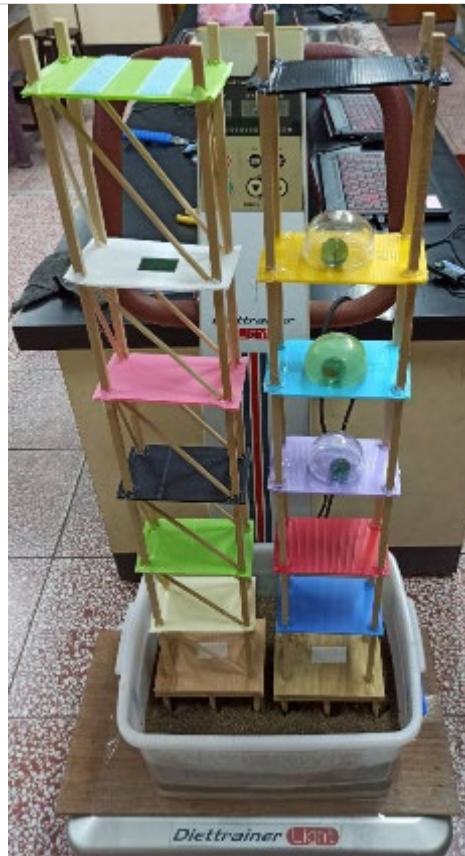
圖十五：單斜撐、阻尼球建築物黏合樁基礎模型
