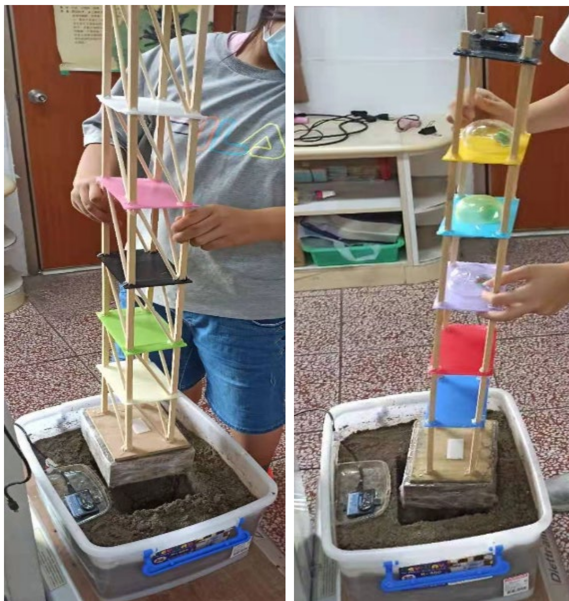
圖十六：單斜撐(左)、阻尼球(右)建築物黏合筏式基礎
