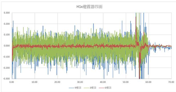
圖 29：大 X 型減震器對不同樓層位移變化
