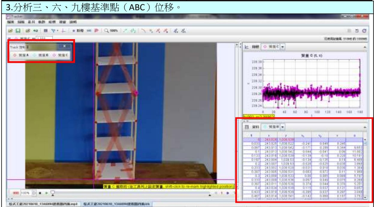
4. 取出三、六、九樓基準點的位置 (X)、速度 (Vx)、速度 (Vy)、加速度(a)資料，利用 Excel 進行位移量的變化統計分析。
