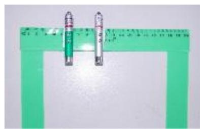
◎把尺放在魚缸內量測 ◎利用游標尺量測(魚缸外不干擾) ◎雷射光游標尺雛型
