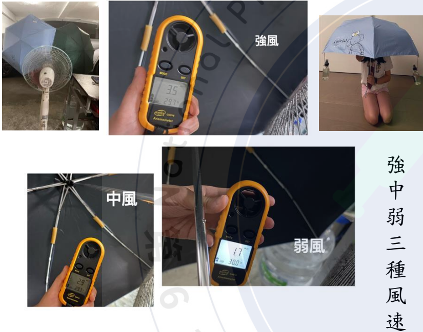
圖21 初步風力測試，仿生效果。 (風速可控制在三段)
