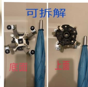
圖 23 初步改成可拆式，方便實驗拆、裝。
