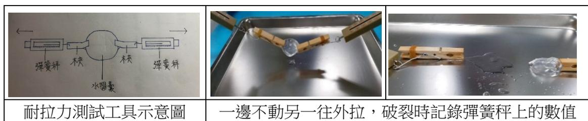
圖十一：耐拉力測試流程圖
