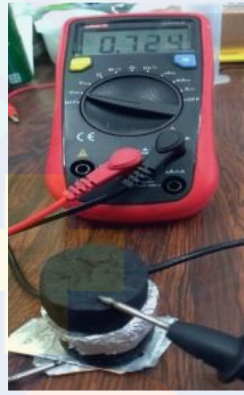
測量電池電壓
