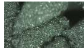
圖 18 活性碳粉表面孔隙放大 100 倍
