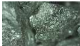
圖 17 活性碳粒表面孔隙放大 100 倍
