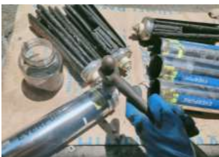
圖 55 碳粉濾心取出曬乾並過篩處理
