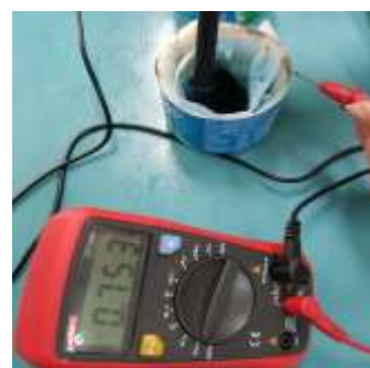
圖 35 隨著時間拉長，鋁空 氣電池持續作用，電 壓數值也微幅下降。
