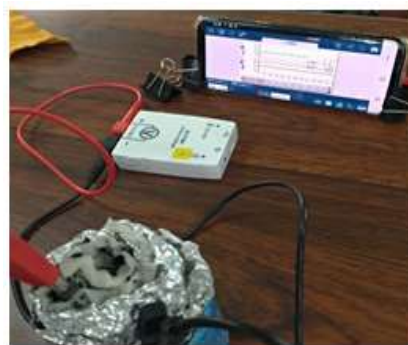
圖 39 以 PASCO 電壓及電流器檢測高低瓶鋁罐電壓電流
