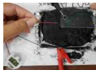
圖 60 串聯碳粉片狀電池後讓電子錶運行
