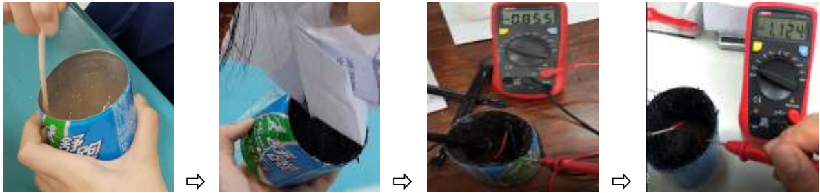
圖 51 塗食鹽果凍 圖 52 壓密活性碳粒 圖 53 以電線當電極 圖 54 檢測電池電壓
