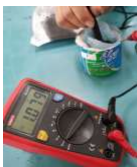
圖 32 檢測活性炭粒加口 罩的鋁空氣電池測 得電壓超過 1 V
