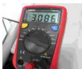
圖 12 串聯備長炭電池測得電壓超過 3V
