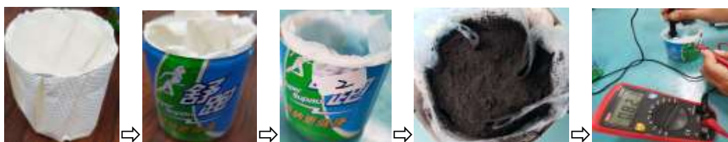
圖 27 厚紗布塑型 圖 28 放入鋁罐中 圖 29 再放入防水布 圖 30 最後放碳粉 圖 31 檢測電池電壓 (滴鹽水後倒放瀝乾)
