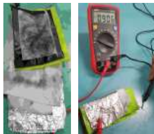
圖 42 實測電壓約 0.9V
