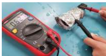
圖 14 木炭鋁空氣電池電壓 0.627 V
