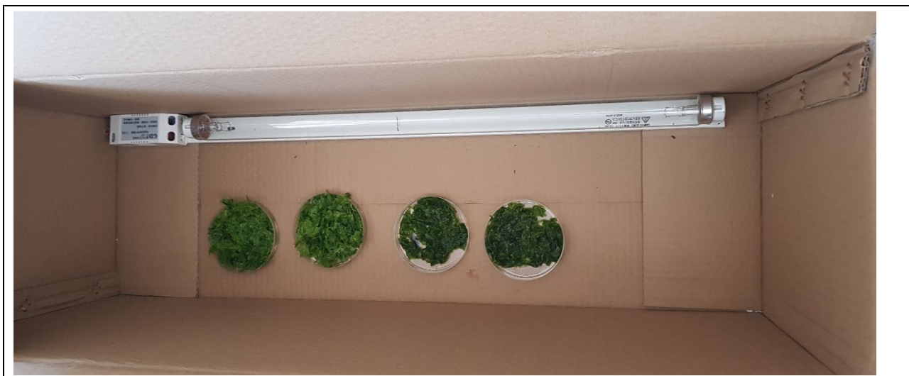
圖 14 自製紫外線燈（開燈時紙箱關閉，人不在現場）
