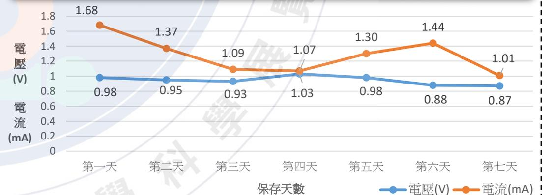
結果：經過連續7天的量測，電壓電流表現僅微幅下降
