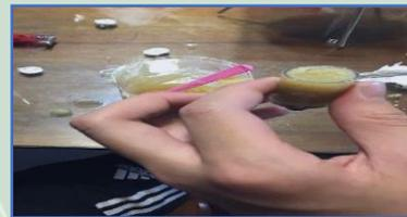
填充固態電解液並封上鋁片
