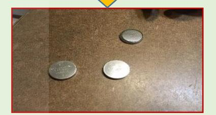
C型夾壓合後，完成葉綠素鈕釦電池製作
