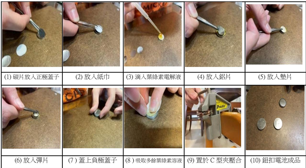
圖 5-22 葉綠素鈕扣電池製作流程圖
