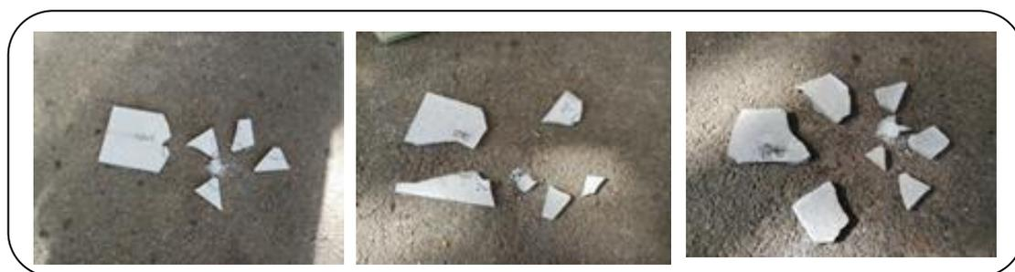
圖 4-2-1:三塊水泥磚在鉛球敲擊下全都一次就粉碎。
