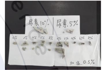
1. 進行水泥磚硬度敲擊實驗後，為求**實驗更精準**，更進一步將所有不同濃度的尿素**水泥磚敲成碎塊**。
