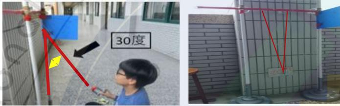
1. 為了能精準測出水泥磚硬度差異，我們設計一個**可以穩定施力又能調整撞擊力的裝置**。
