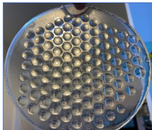
圖 13 靜置兩天後脫膜的矽膠複眼膜
