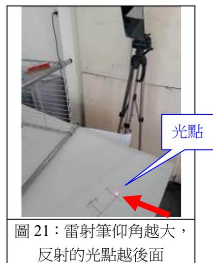
圖 21：雷射筆仰角越大，反射的光點越後面
