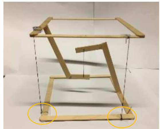
精確的控制變因： 外側平衡線黏貼在冰棒棍的外側
