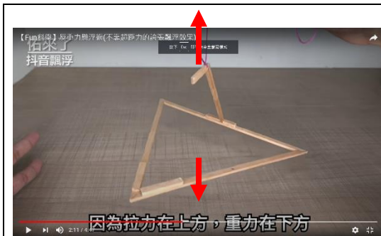
圖 1-1-1 三角形架可以平衡是因為拉力在上方，重力在下方
