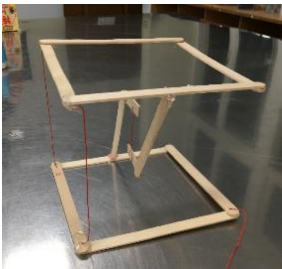
外側平衡 2 條達到正方形的「互」字型反重力懸浮裝置平衡
