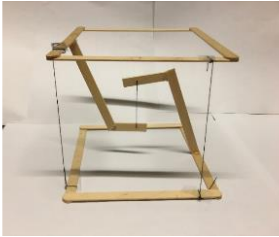
即使上架中心軸平邊與下架中心軸平邊兩邊沒有平形，中心軸線必垂直於桌面。 圖 4-2-6
