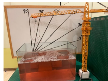
圖 3-2：透過起重機沿著不同傾角拿出立體模型框架
