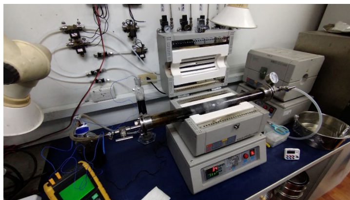
圖七、管狀高溫爐，國立高雄科技大學化工與材料工程系仿生實驗室儀器
