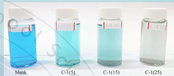
圖七、C-1 銀合歡木碳甲基藍水溶液吸附脫色實驗
