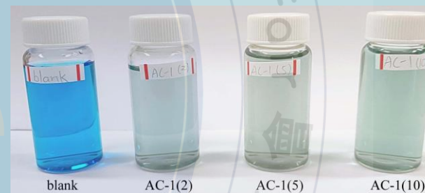
圖八、AC-1 銀合歡活性碳甲基藍水溶液吸附脫色實驗
