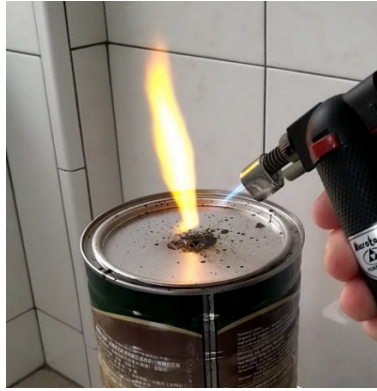
圖五、燒製過程中釋出可燃性氣體
