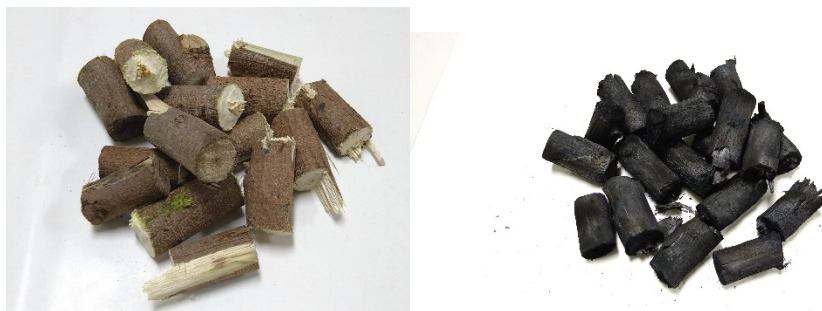
圖四、圖左為銀合歡切塊，圖右為銀合歡木炭 AC-1
