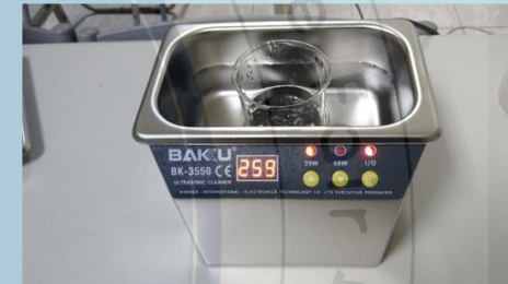
圖三、超音波震盪器進行甲基藍色素釋出實驗
