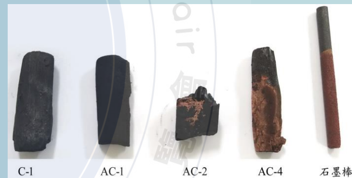
圖十三、各碳樣品導電性實驗電解電鍍銅結果
