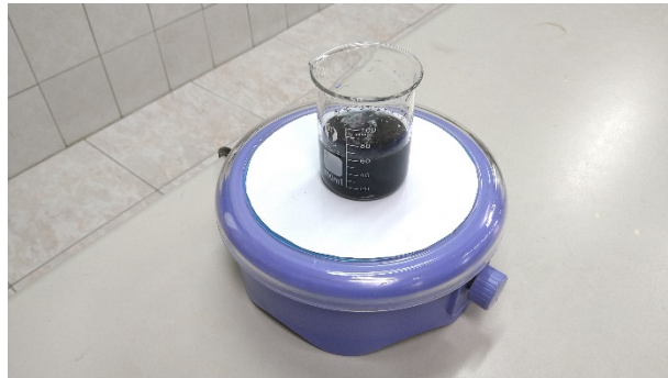
圖八、電磁攪拌器進行甲基藍水溶液吸附脫色實驗
