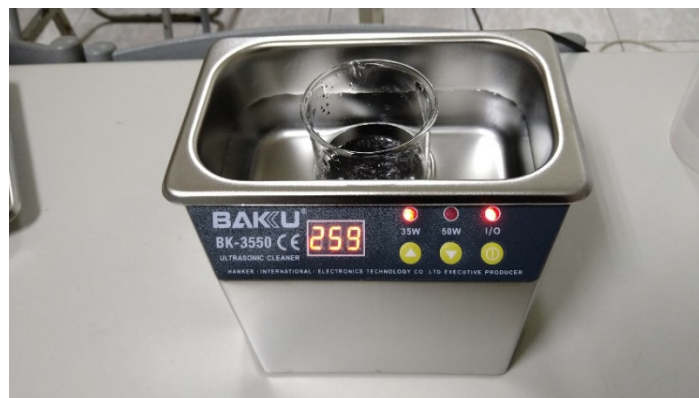
圖九、超音波震盪器進行甲基藍色素釋出實驗
