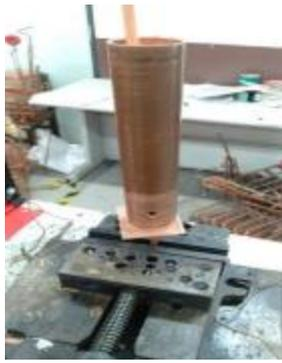
圖 44 製作殼管式熱交換器(外部)
