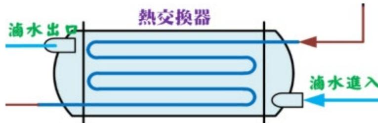
圖 2 殼管式熱交換器示意圖
