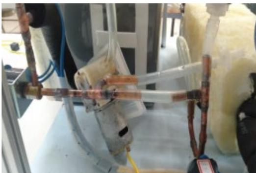
圖 50 製作滷水管路
