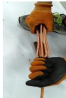
圖 4 殼管式熱交換器(內管)
