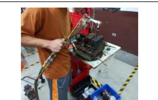
圖 43 焊接冷媒管路
