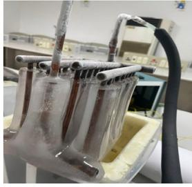
圖 67 高直管流道結冰情形
