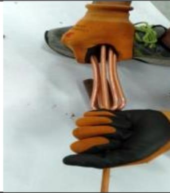
圖 45 製作殼管式熱交換器(內部)
