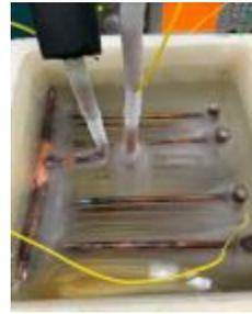
圖 71 橫管流道結冰情形
