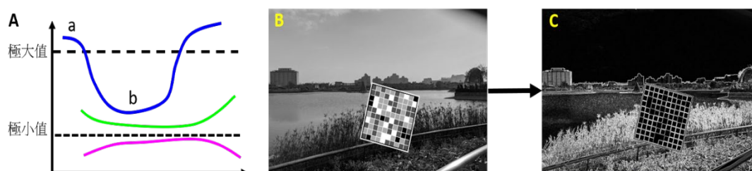
圖 4. Canny edge detection (A)邊緣連線原理 (B)原始影像 (C)邊緣檢測法。
