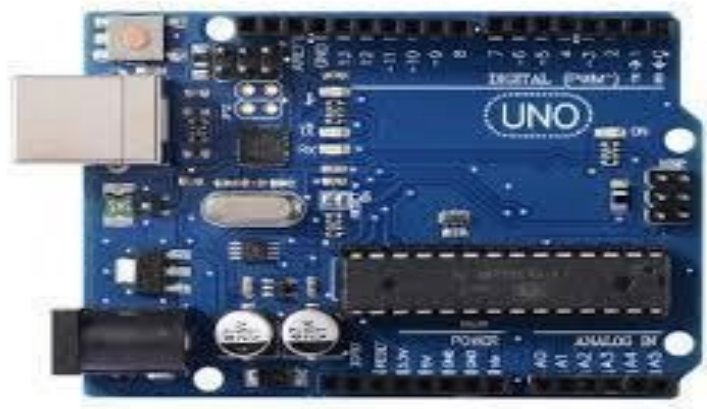
圖 10 Arduino Uno 程式開發版
