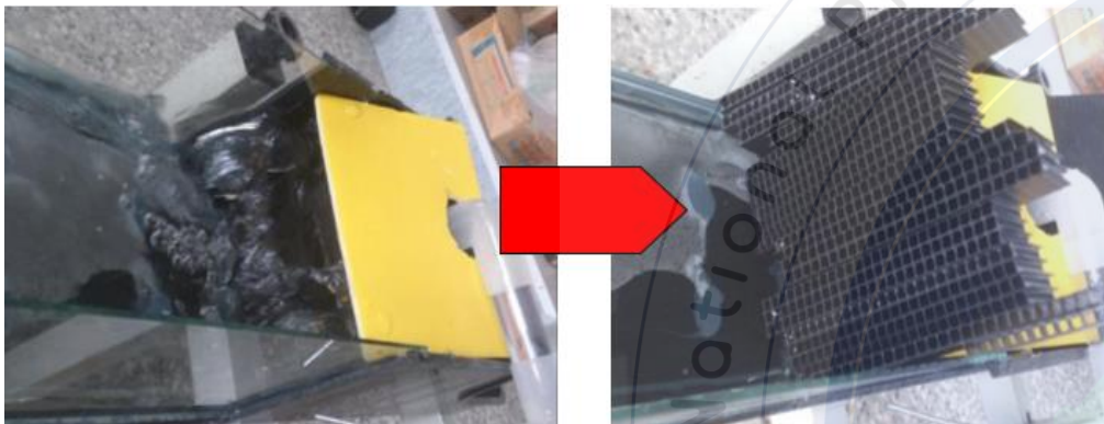
圖3 入水口穩流的設計方式
