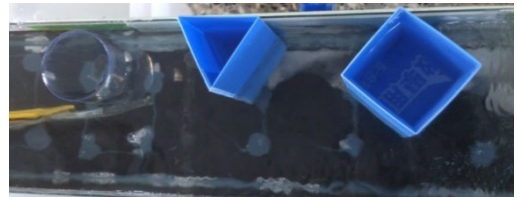
圖 21 橋墩位於渠道位置
