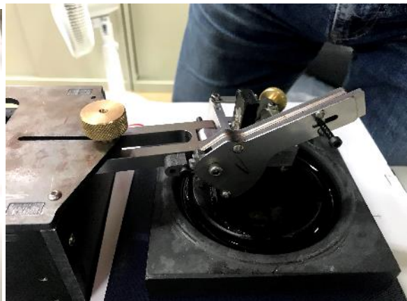
圖 37 加壓機構安裝於連桿上
