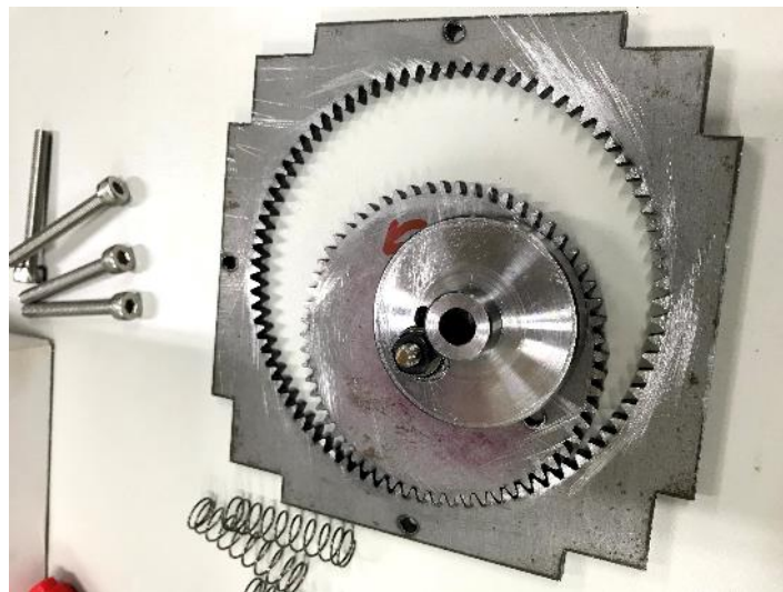
圖 25 齒輪零件加工完成品
