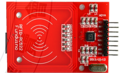
Fig4 感應晶片及RC522示意圖
