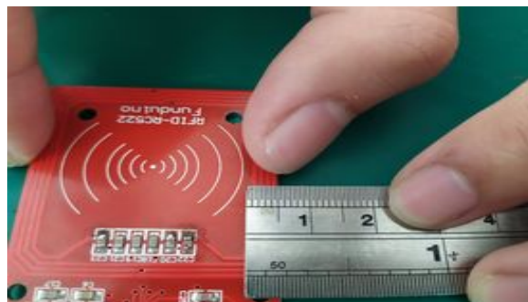
《圖 36》量測 RFID 的天線長、寬、高。
