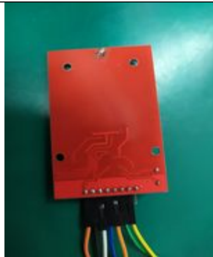
《圖 39》RFID 背面印刷電路板
