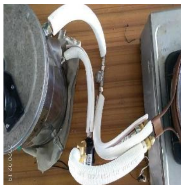
圖74完整包覆保溫材質
