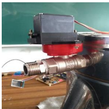
圖67 安裝電動水閥
