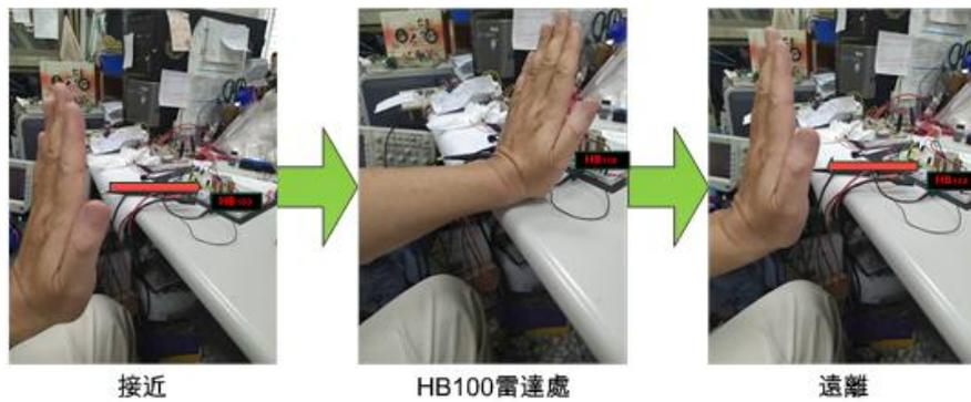
圖 31 手與 HB100 微波雷達模組連續執行一次接近、停留和遠離相對運動的過程照片
