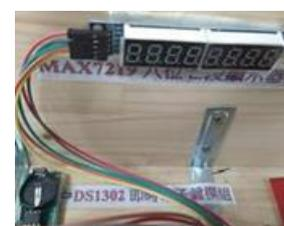
DS1302 即時電子時鐘模組不斷電，則模組的時間計時結果基本上都會與網路時間同步的。每當跌倒偵測器檢測到被檢測目標發生跌倒事件，跌倒偵測器內的單晶片(PIC16F883)就會立即讀取當下的 DS1302 即時電子時鐘模組內的時、分、秒時間，並將這些時間儲存在單晶片的 EEPROM 記憶體內，提供日後對被檢測目標的跌倒事件做離線追蹤之用。
