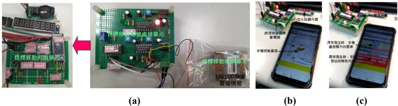
圖9 (a)完成後的跌倒偵測器實驗模型 (b)跌倒前智慧手機螢幕及時顯示畫面 (c)跌倒後智慧手機螢幕及時顯示畫面
