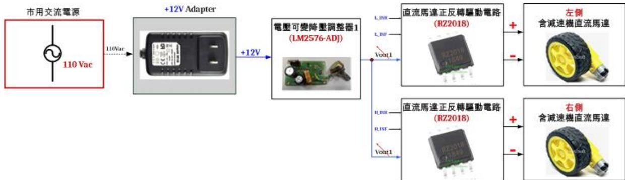
圖17 行進速度和行進方向的硬體控制電路功能組成方塊圖
