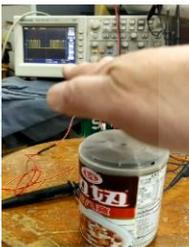
手從鐵罐正上方接近微波雷達模組
