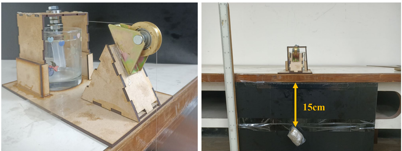
圖六、黏滯係數測試裝置。左圖為側面角度拍攝；右圖為正面角度拍攝
