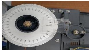
圖 12. 測試波段轉盤
